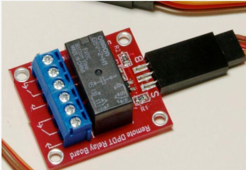
Ein Remote-Relais kann angeschlossen werden, um ein Herzstück zu schalten, oder ein Feedback für ein Meldesystem zu steuern. Abgebildet sehen Sie die Verkabelung für das Remote-Relais.
