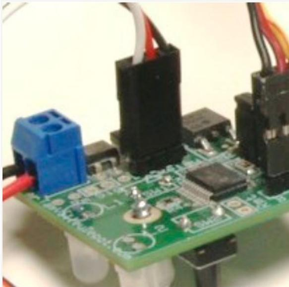
Stecken Sie das Remote Relais so ein, dass der weiße (Signal-) Draht in der Nähe des weißes Dreieck auf der Leiterplatte liegt.
